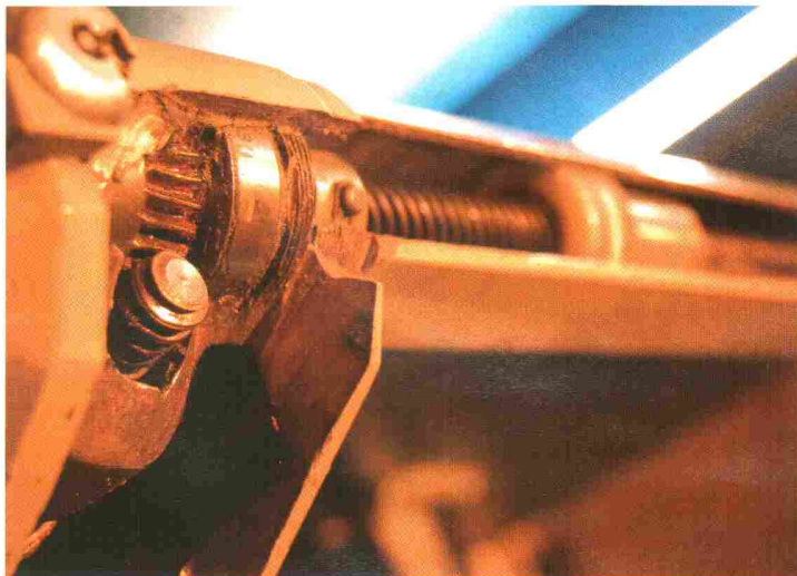
◀ Lükandvärava vastasposti ülaossa paigaldatava püüduri ülesanne on raami kõikumise ärahoidmine tuule ja inimeste mõjul.
